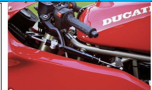
1/ Monter la bride de fourche sur le canon gauche. Positionner la bride de fourche afin d'avoir une distance de 103 mm entre le Té de fourche inférieur et la bride de fourche.
