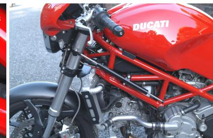
1/ Monter la bride de fourche sur le canon gauche. Positionner la bride de fourche afin d'avoir une distance de 71 mm entre le Té de fourche inférieur et la bride de fourche.
