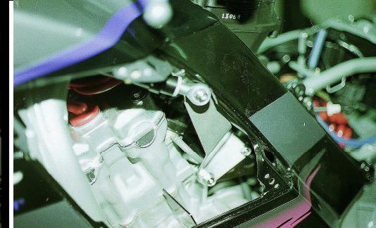
1/ Démonter le flanc de selle et carénage du côté gauche. Enlever le conduit de la prise d'air fixée sur le flanc de carénage.
