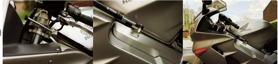
1/ Monter la bride de fourche sur le canon gauche. Positionner la bride de fourche afin d'avoir une distance de 169 mm entre le Té de fourche inférieur et la bride de fourche.
