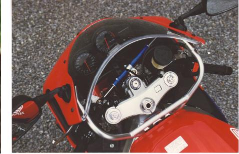
1/ Monter la bride de fourche sur le canon gauche. Positionner la bride de fourche afin d'avoir une distance de 76 mm entre le Té de fourche inférieur et la bride de fourche.
