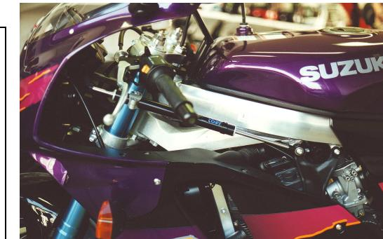
1/ Monter la bride de fourche sur le canon gauche. Positionner la bride de fourche afin d'avoir une distance de 83 mm entre le Té de fourche inférieur et la bride de fourche.
