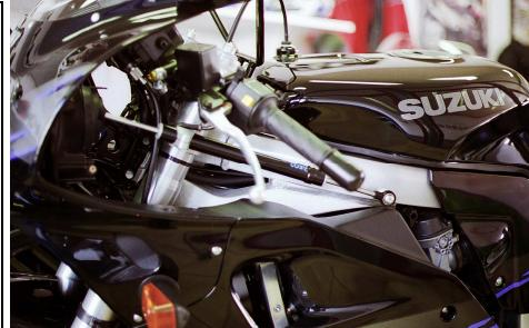
1/ Monter la bride de fourche sur le canon gauche. Positionner la bride de fourche afin d'avoir une distance de 99 mm entre le Té de fourche inférieur et la bride de fourche.
