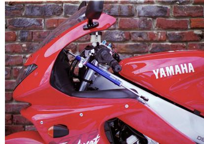
1/ Monter la bride de fourche sur le canon gauche. Positionner la bride de fourche afin d'avoir une distance de 173 mm entre le Té de fourche inférieur et la bride de fourche.
