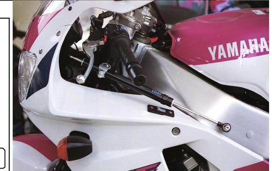
1/ Monter la bride de fourche sur le canon gauche. Positionner la bride de fourche afin d'avoir une distance de 90 mm entre le Té de fourche inférieur et la bride de fourche.
