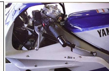
1/ Monter la bride de fourche sur le canon gauche. Positionner la bride de fourche afin d'avoir une distance de 122 mm entre le Té de fourche inférieur et la bride de fourche.
