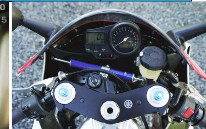
1/ Monter la bride de fourche sur le canon droit. Positionner la bride de fourche afin d'avoir une distance de 97 mm entre le Té de fourche inférieur et la bride de fourche.
